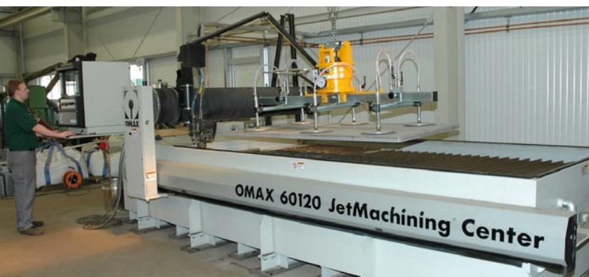
Links: Die Wasserstrahlschneidanlage Omax 60120 bietet einen Arbeitsbereich von 3000 mm x 1500 mm.
